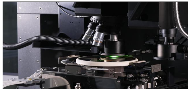
반도체 웨이퍼 AOI(Automated Optical Inspection) 장비
